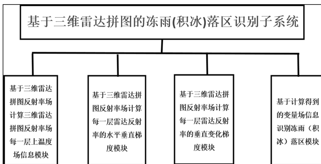
基于三维雷达拼图的冻雨（结冰）落区识别系统模块图
